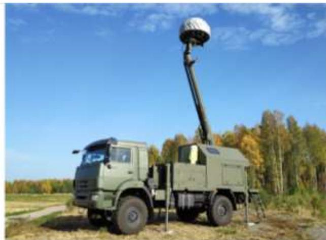
Рис. 3. Пример размещения приёмной позиции бистатической РЛС, разработанной в рамках СЧ ОКР «ХТ-АПООССИ»
