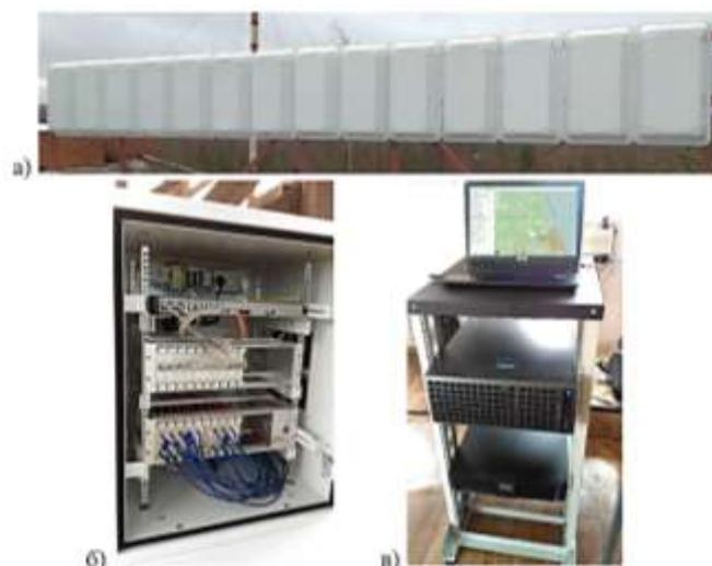
Рис. 1. Антенная система (а), устройство приёма сигналов (б), вычислитель (в) пассивного когерентного локатора, разработанного в рамках ОКР «Охрана»
